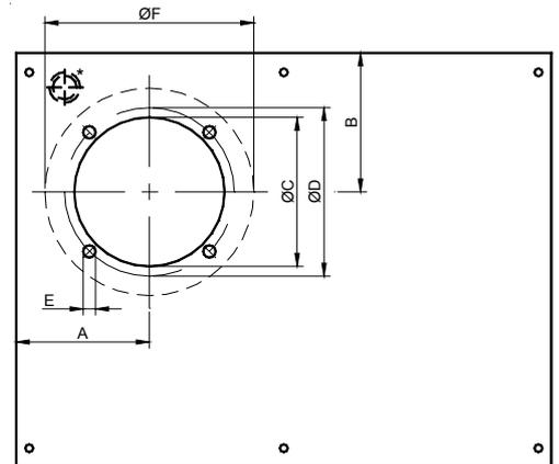
\*Gewinde für Einfüllstutzen bei Tank TA 15
