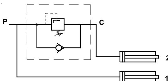
Der Zylinder 2 wird erst ausfahren sobald der Zylinder 1 ausgefahren ist und der Druck sich soweit aufgebaut hat das das Druckfolgeventil die Leitung frei gibt.
